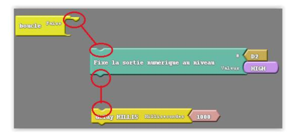
Nous distinguons des trous en haut et des bosses en bas permettant de les chaîner avec les autres et des trous sur les côtés appelés « sockets »
