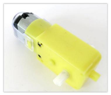
Les moteurs à courant continu possèdent souvent une boite de réduction afin d'augmenter leur couple pour un encombrement réduit.
