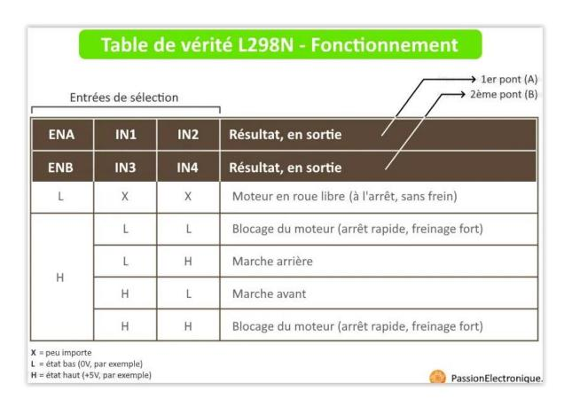
Pour contrôler la vitesse de rotation des moteurs on doit retirer les cavaliers des pins ENA et ENB.
