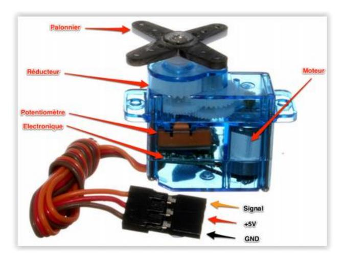
Les servomoteurs sont contrôlés en envoyant un signal PWM (modulation de largeur d'impulsion) à la ligne de signal du servo.
