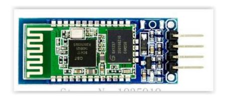
Le module Bluetooth HC-06 permet d'établir une liaison Bluetooth (liaison série) entre une carte Arduino et un autre équipement possédant une connexion Bluetooth (Smartphone, tablette, seconde carte Arduino, etc....).
