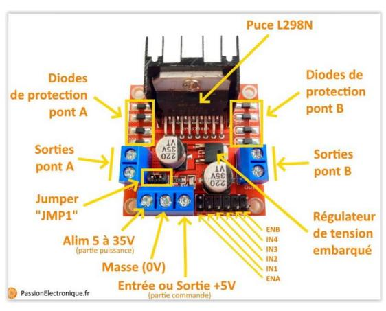
Avec le cavalier régulateur on peut contrôler des moteurs de 5 à 12 V et on pourra utiliser la broche de 5 V du module pour alimenter l'Arduino.
