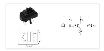
**La LED infrarouge** émet un rayonnement dans une longueur d'onde infrarouge (950 nm) donc invisible à l'œil humain. Si un obstacle réfléchissant se trouve sur le trajet du faisceau, il renvoie une partie de l'énergie qui tombe ensuite sur **le phototransistor**. Ce dernier fonctionne comme interrupteur commandé par la lumière infrarouge qu'il reçoit :
