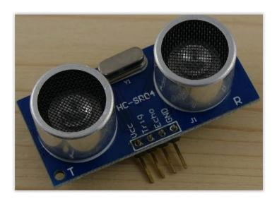
Ce capteur fonctionne avec une tension d'alimentation de 5 volts, dispose d'un angle de mesure de 15° environ et permet de faire des mesures de distance entre 2 centimètres et 4 mètres avec une précision de 3mm (en théorie, dans la pratique ce n'est pas tout à fait exact).
