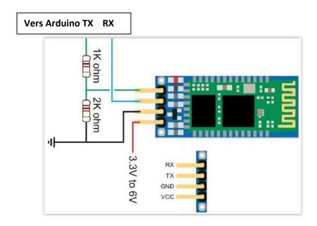
Il faudra bien penser à inverser les broches Rx et Tx entre la carte Arduino et le module Bluetooth
