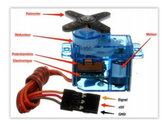
Les servomoteurs sont contrôlés en envoyant un signal PWM (modulation de largeur d'impulsion) à l'entrée signal du servo.
