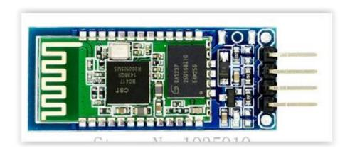
Le module Bluetooth HC-06 permet d'établir une liaison Bluetooth (liaison série) entre une carte Arduino et un autre équipement possédant une connexion Bluetooth (Smartphone, tablette, seconde carte Arduino, etc....).
