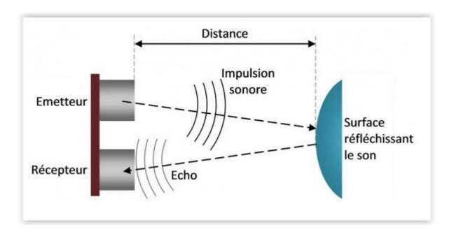
La **durée** entre l'instant de l'émission et l'instant de la réception peut être mesurée. Le signal ayant parcouru 2 fois la **distance** entre le capteur et la surface (un aller-retour), on peut la calculer ainsi :
