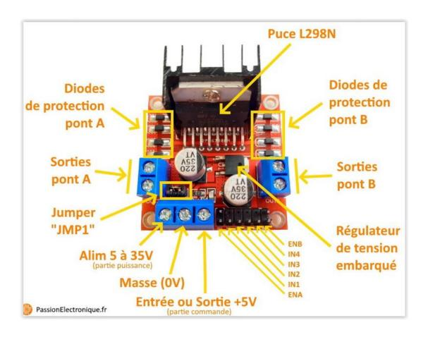
Avec le cavalier régulateur on peut contrôler des moteurs de 5 à 12 V et on pourra utiliser la broche de 5 V du module pour alimenter l'Arduino.
