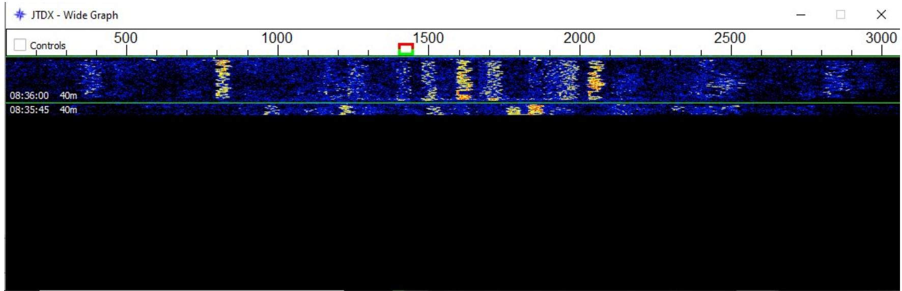
Une chute d'eau (waterfall) permet de visualiser les signaux sur l'ensemble de la bande
